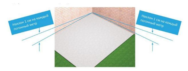
Для отвода дождевой и талой воды в случае бетонной стяжки рекомендуется делать уклоны от статических сооружений (1 см на каждый 1 погонный метр) или дренаж во всех других случаях.
