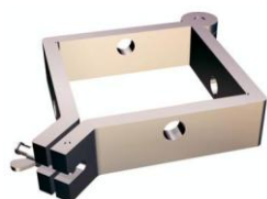
Шаблон для сверления отверстий в столбах
